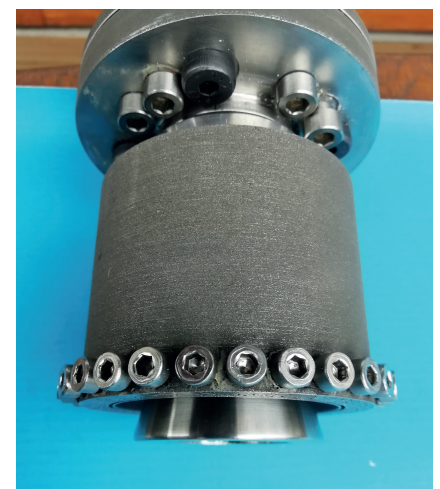
Bild 5. Konischer Dorn, der zur Einstellung des maximal möglichen Düsenpals weit aus der Düse herausgefahren wurde © Groß
