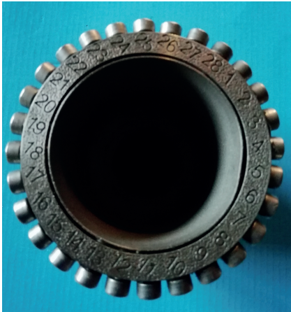
Bild 2. Flexringdüse (Durchmesser 50 mm), bei der der flexible Ring mithilfe der Schraube Nr. 5 lokal begrenzt verformt worden ist ©Groß
